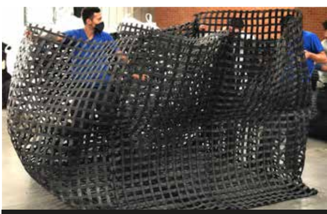
Fotografía 4. Contenedor prefabricado en planta de Geomatrix con HIDROMALLA GEOESTERA® 300. Peso del módulo vacío: 53 Kg.
